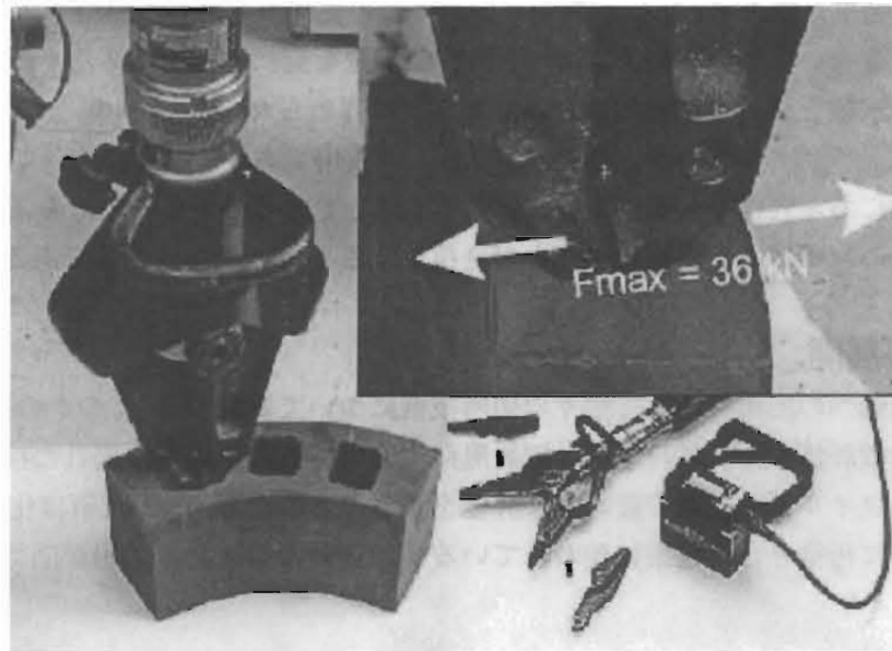
図1 黒鉛構造物の破砕
